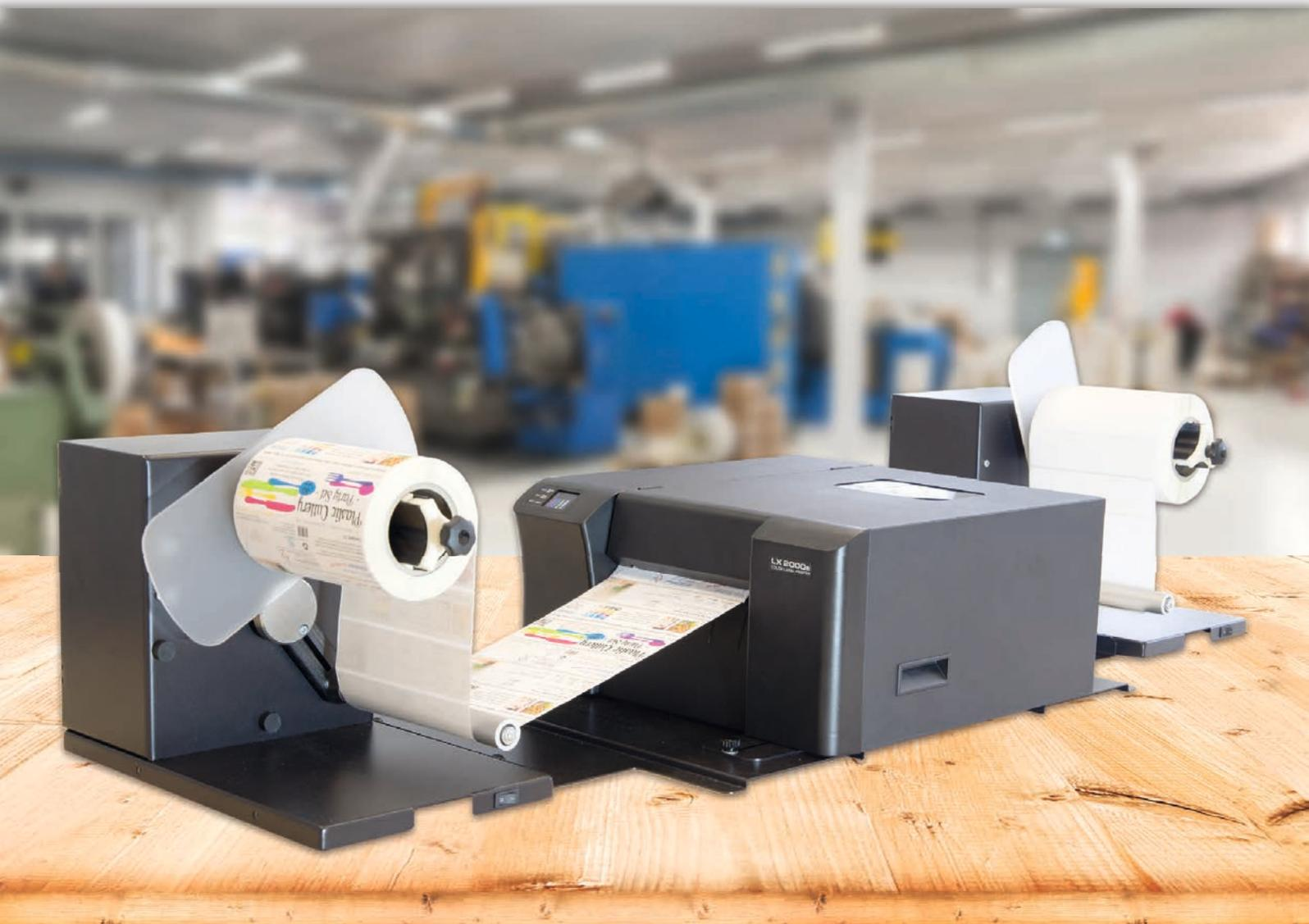
Diese neuen Auf- und Abwickler werden in Deutschland hergestellt und eignen sich aufgrund der Bauweise und Leistung für den Industrieinsatz. Beide Modelle bestehen aus einem zwei Millimeter starken Stahlgehäuse und verfügen über einen leistungsstarken Linearmotorantrieb. Zudem kann die verstärkte Vollmetall-Aufnahmeachse Rollen mit einem Gewicht bis zu 30 Kilogramm, einer Breite von 228 Millimeter, einem 76 Millimeter-Kern und einem maximalen Außendurchmesser von 330 Millimeter tragen.
